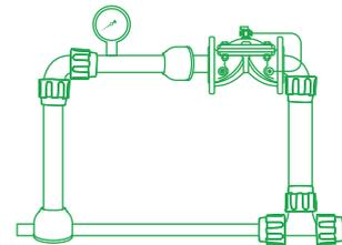
Alta qualidade e durabilidade, os cavaletes de polietileno também contam com conexões de compressão que garantem flexibilidade de uso no campo.
